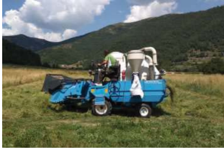
Figura nº 1: Cosechadora utilizada en los ensayos de Linás de Broto (Aragón). Modelo, Wintersteiger Nursery Master.
