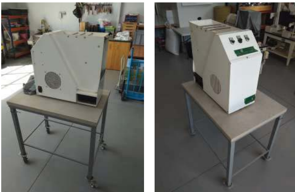
Figura nº 19: Aventadora de sobremesa con regulación del caudal de aire, marca Seed Processing 4601 00 00.
