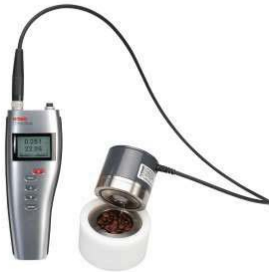
Figura nº 24: Termohigrómetro con sonda Rotronic Hygropalm.
