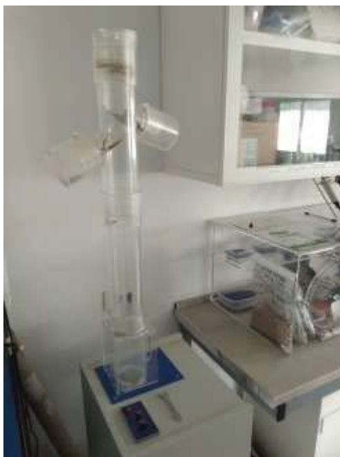
Figura nº 18: Aventadora por columna de aire vertical.
