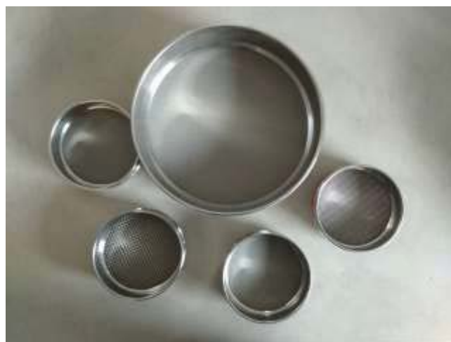
Figura nº 21: Juego de cribas de laboratorio empleadas para la limpieza de las muestras.
