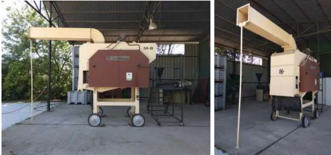
Figura nº 20: Aventadora/cribadora industrial, MORESIL M-8.
