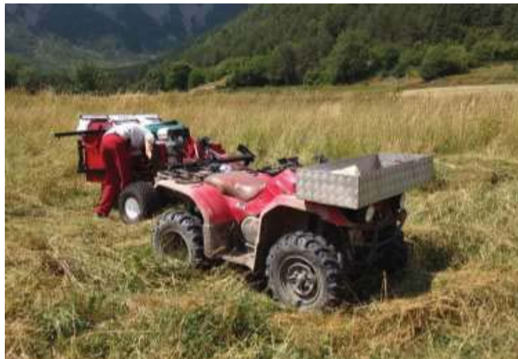
Figura nº 9: Quad adaptado para arrastrar una barredora, tomada en Linás de Broto (Aragón).
